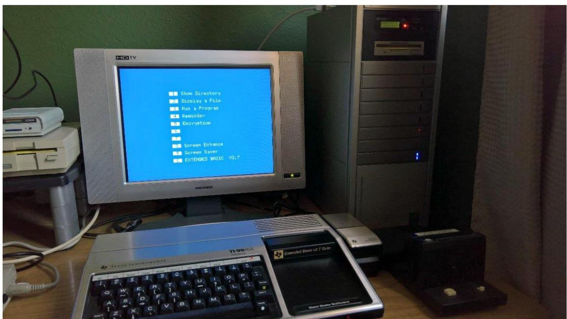
Il mio sistema TI-99/4A è costituito da una **console nero-argento** dotata di aggiornamento **F18A**, **sintetizzatore vocale** ed una **PEB (Peripheral Expansion Box)**. Nel Box di Espansione (PEB) c'è una scheda **TI RS-232** non modificata, una scheda **TI Disk Controller** con aggiornamento a 80 tracce e l'ultima scheda di memoria **Super AMS da 1MB**.
