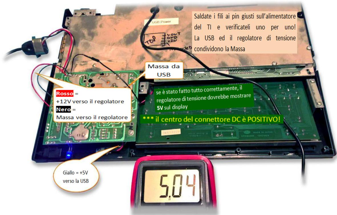
Da notare nella foto che il piccolo regolatore di tensione stepdown da 12V a 5V è ben nascosto al di sotto della scheda circuitale dell'alimentatore.
