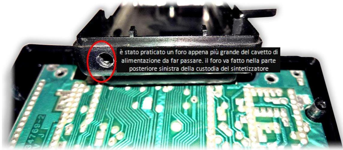
**Passo 5:** fate passare il cavetto attraverso il foro praticato come al punto precedente. Saldare i fili per il cavetto al connettore dell'adattatore DC: **positivo** al polo centrale
