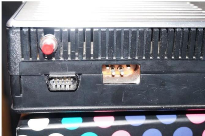
Si dispone ora di un pulsante di reset. È possibile montare l'interruttore ovunque e può essere di qualsiasi tipo purché 'normalmente aperto'. Se si dovesse scegliere di montarlo in un altro posto assicurarsi di utilizzare la giusta quantità di filo e che il pulsante non interferisca con la console in nessun modo.
